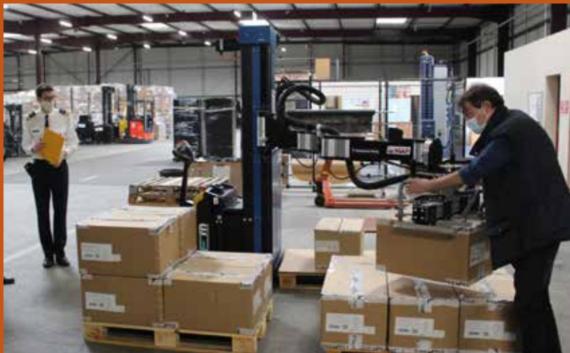
Bras de manipulation installé sur un transpalette électrique pour la prise de caisses, cartons et sacs dans les entrepôts logistiques
