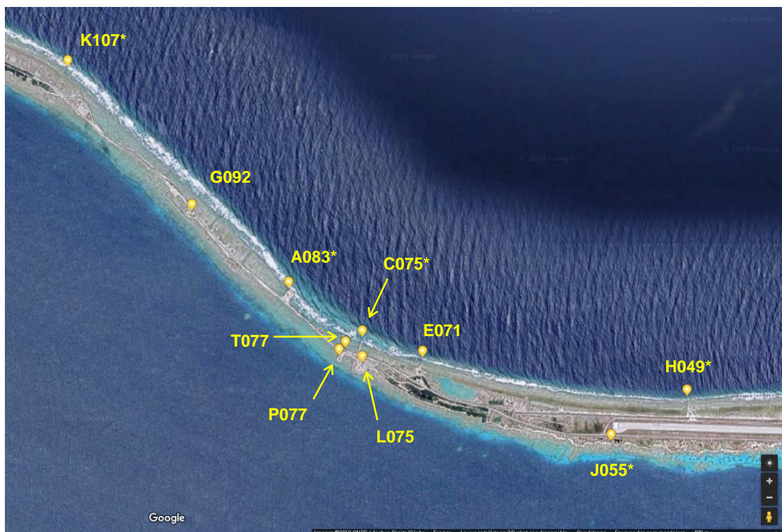
Figure 16 : Localisation des dix stations GPS du système TELSITE actuel (fond de carte extrait de Google Maps). Cinq stations marquées par un astérisque ont une station équivalente dans le système précédent : J055, H049, C075, A083 et K107 ont respectivement remplacé JEANNE, HOTEL, GPS1, ALPHA et KILO.
