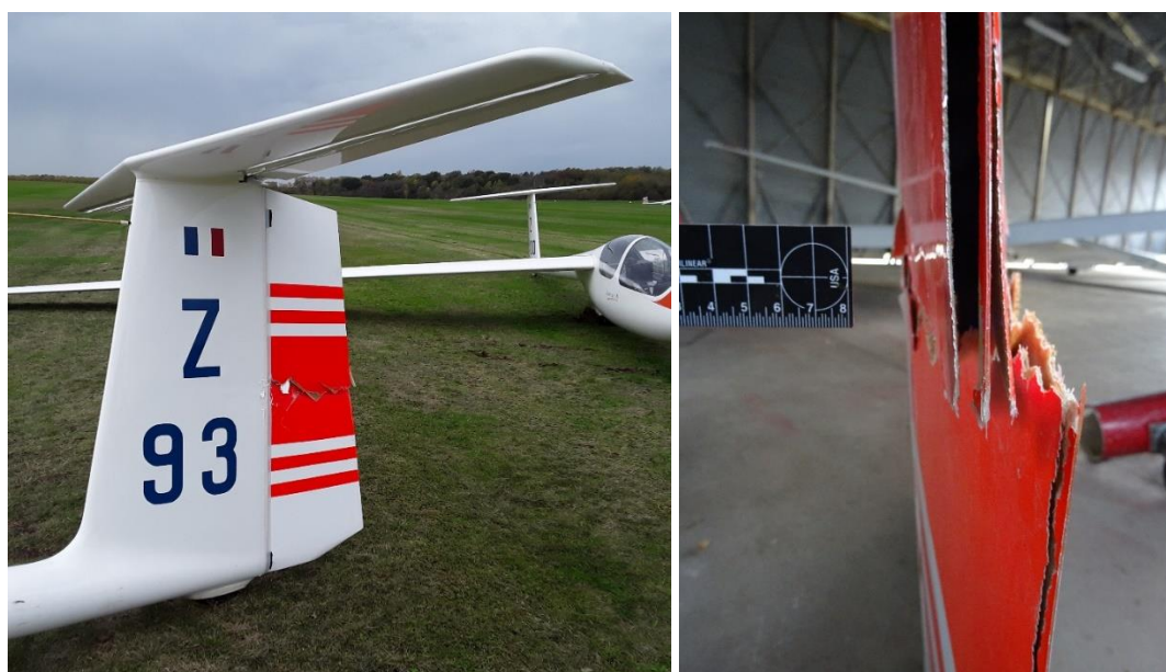
Figure 5 : endommagement de la dérive du Z93, avec sur la droite une vue en gros plan du délaminiage
