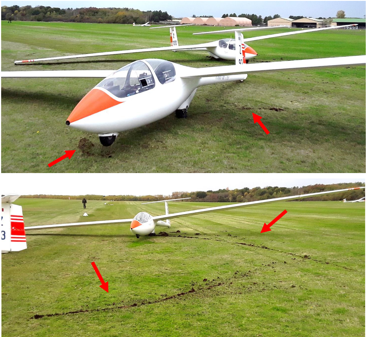
Figure 6 : traces laissées au sol par le Z93 en haut et par le Z100 en bas
