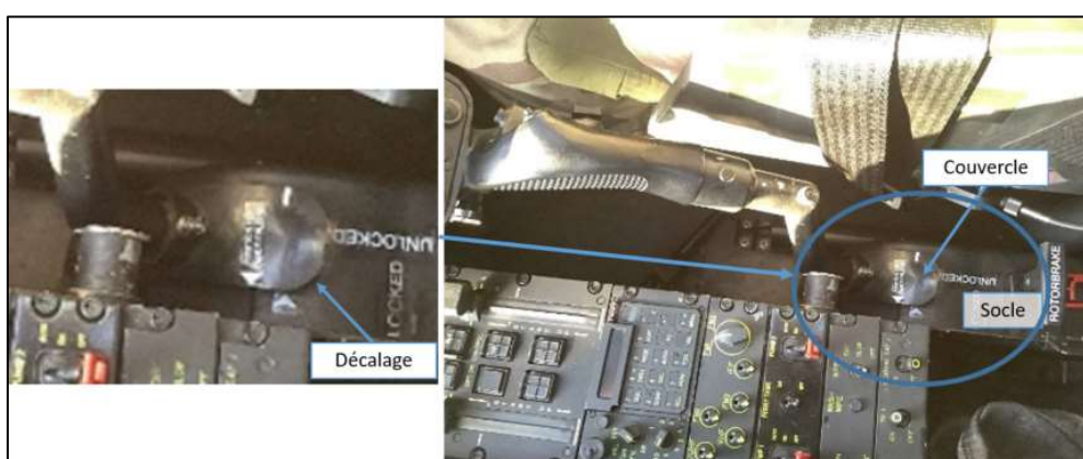
Figure 4 : position du manche avec un mauvais montage
