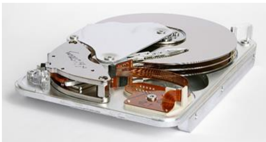
Vue interne d'un disque dur contenant 3 plateaux superposés – Source : Wikipedia
