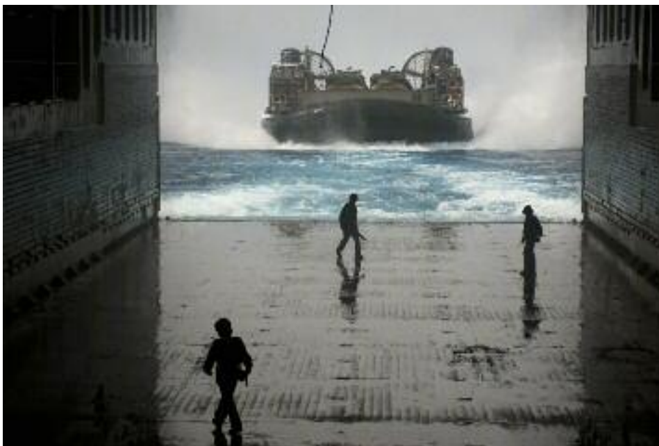
Sur le bâtiment de projection et de commandement Tonnerre , les marins vérifient que rien n'entrave la manœuvre pour l'entrée du Landing craft air cushioned (LCAC) dans le radier. Mer Méditerranée, 7 juin 2011. Positif numérique couleur © Arnaud Roiné/ECPAD/Défense/2011ECPA167A032_045
