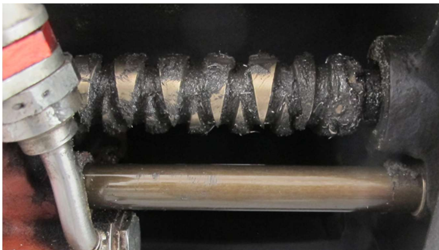
Figure 29 : vue de la graisse sur la vis après l'évènement
