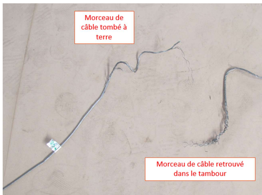
Figure 20 : portions du câble où a eu lieu la rupture
