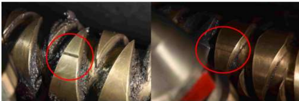
Figure 28 : marques sur la vis d'enroulement
