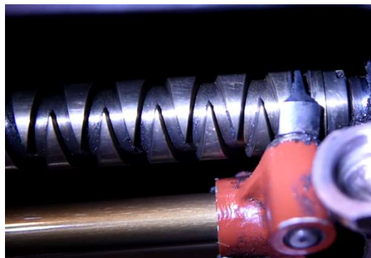
Figure 24 : position dans laquelle se bloque le guide câble dans le sens de l'enroulement
