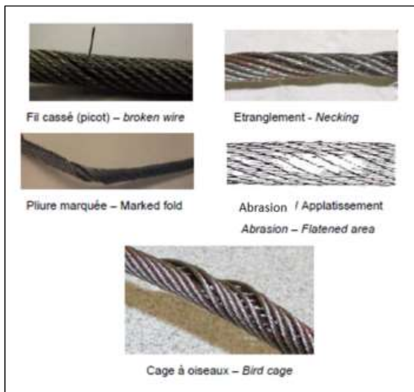
Figure 12 : illustration des endommagements possibles d'un câble
