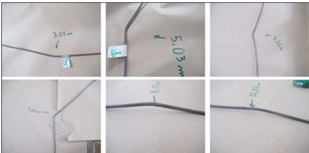
Figure 18 : pliures (six) du câble tombé à terre
