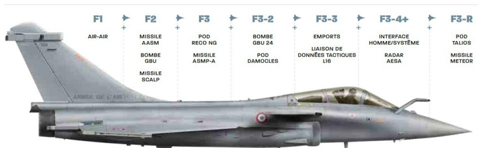
À partir de 2022, le Rafale disposera encore de nouvelles capacités avec le standard F4. Il disposera notamment de solutions de connectivité innovantes pour optimiser le combat en réseau, de capteurs radar et optronique secteur frontal améliorés, d'une capacité viseur de casque et de nouveaux armements intégrés tels que le missile air-air Mica NG et l'armement air-sol modulaire de 1000 kg.
