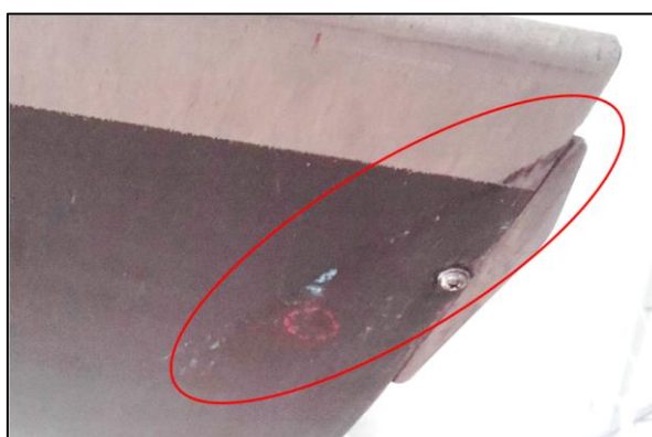
Figure 3 : traces de frottement sur la pale jaune 11
