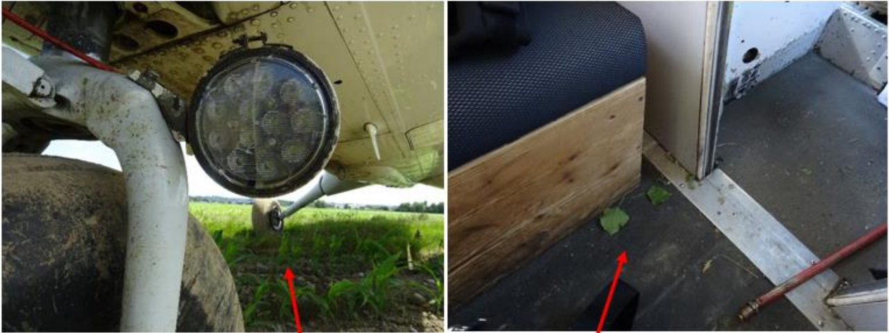
Figure 8 : phare d'atterrissage endommagé / végétation à l'intérieur de l'appareil
