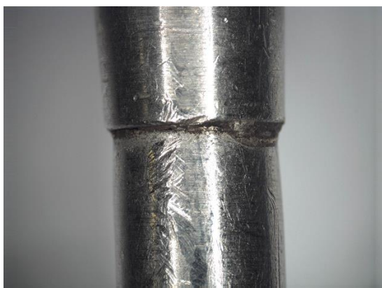
Figure 18 : marquages et éraflures
