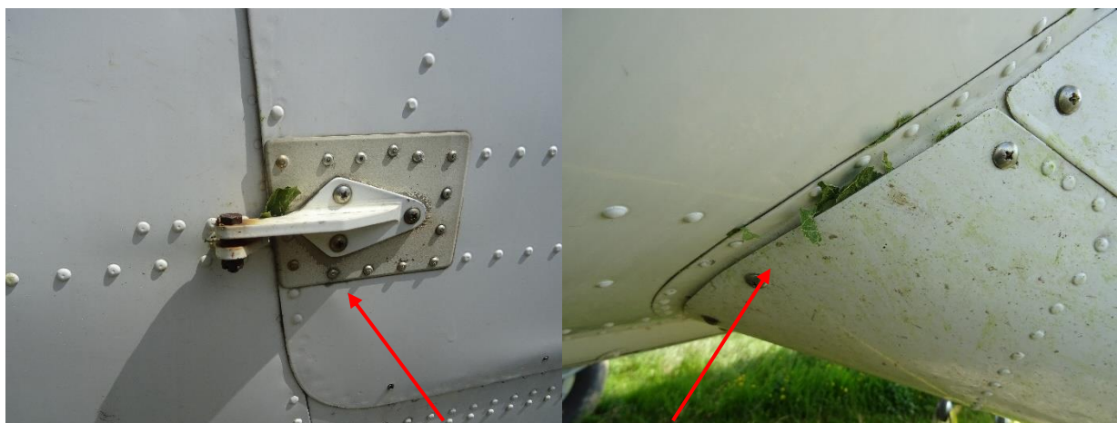
Figure 7 : feuillages dans les ferrures et emplantures de trains d'atterrissage
