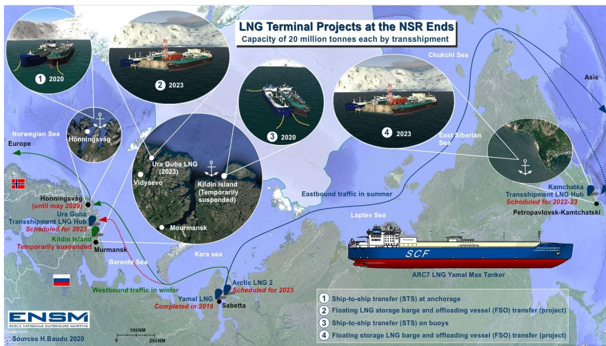
Figure 1 : Projet de Hubs de transfert de GNL aux extrémités de la route maritime du Nord (© Hervé Baudu)
