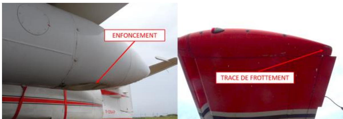
Figure 7 : enfoncement du ballonnet gauche et trace de frottement sur le saumon d'aile gauche
