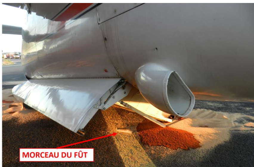
Figure 4 : vue de la nacelle et du train principal gauche rentré dans celle-ci
