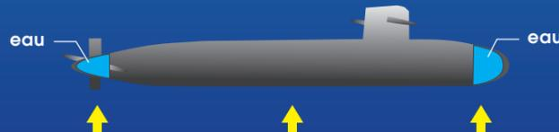
**A** Le sous-marin est en surface, il est en équilibre hydrostatique, son poids est égal à la poussée en surface.
