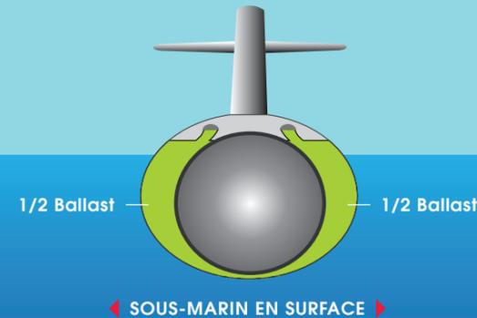
**B** Les ballasts se remplissent d'eau. La poussée diminue.
