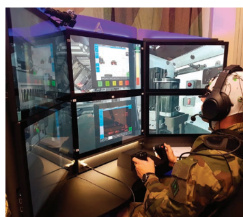
Expérimentation d'une méthode d'évaluation de l'état cognitif (charge mentale et stress) à partir de l'analyse de l'activité cérébrale du soldat en situation de pilotage de véhicules blindés.
