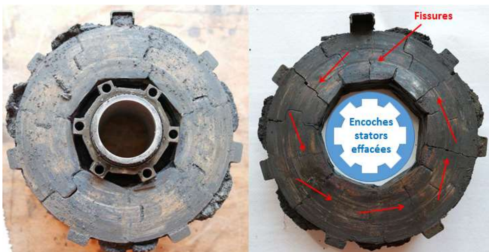
Figure 14 : rotors et stators internes avant séparation
