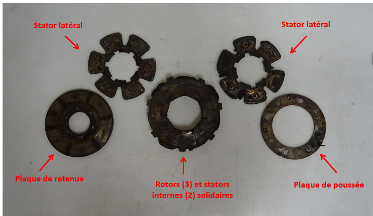
Figure 11 : ensemble « parties chaudes » démonté
