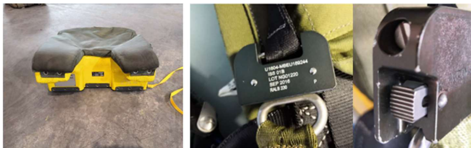
Figure 25 : coque du paquetage de survie et libérateur de la sangle de retenue du paquetage de survie
