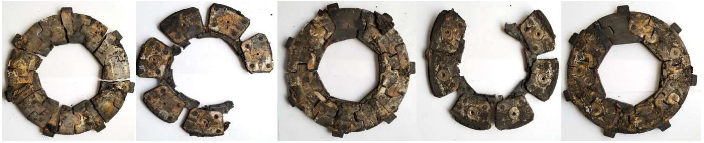
Figure 15 : rotors et stators internes après séparation
