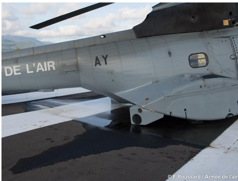
Figure 5 : vue du ballonnet droit et du carburant répandu
