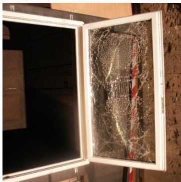
Figure 4 : Panneau vitré soumis à une onde de surpression. Apport d'un film en face arrière afin de maintenir les fragments de verre.
