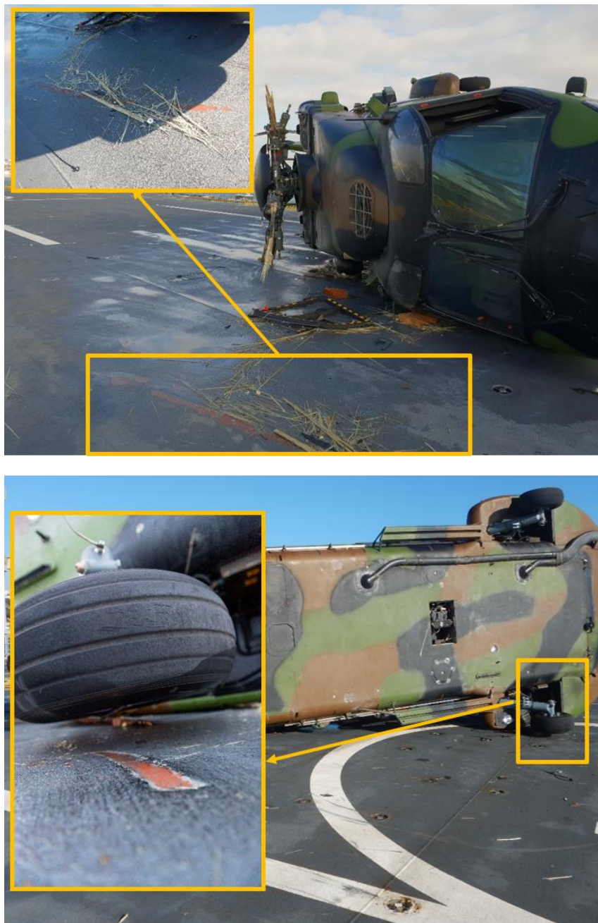
Figure 1 : vues des abrasions du revêtement du pont d'envol
