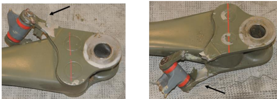
Figure 21 : amortisseur de pale rouge déformé vers la pale
