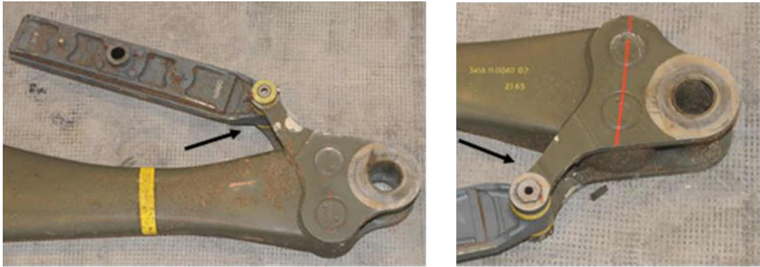
Figure 22 : amortisseur de pale jaune déformé vers le manchon
