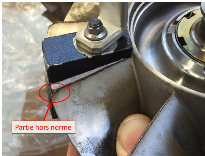
Figure 10 : application de la cale de gabarit sur une aube du compresseur axial
