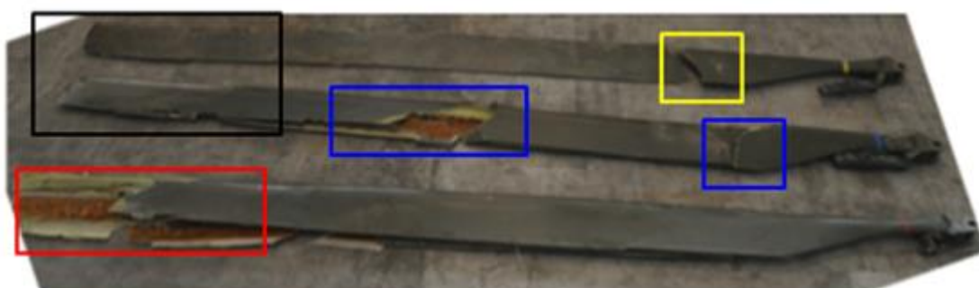
Figure 20 : endommagement des pales jaune, bleue et rouge
