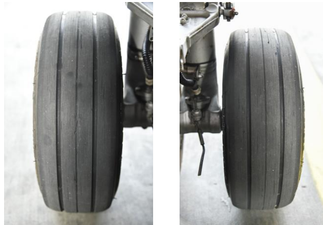
Figure 7 : pneumatiques du train principal non endommagés
