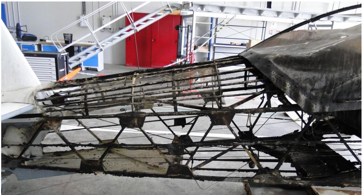
Figure 7 : état de l'arrière du fuselage
