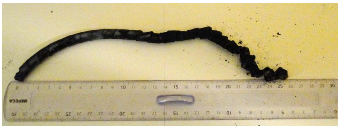
Figure 22 : morceau de tuyauterie retrouvé sur la piste
