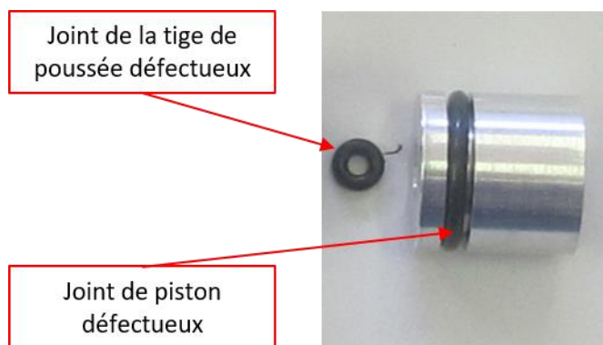
Figure 12 : composition interne d'un maître-cylindre, joints défectueux
