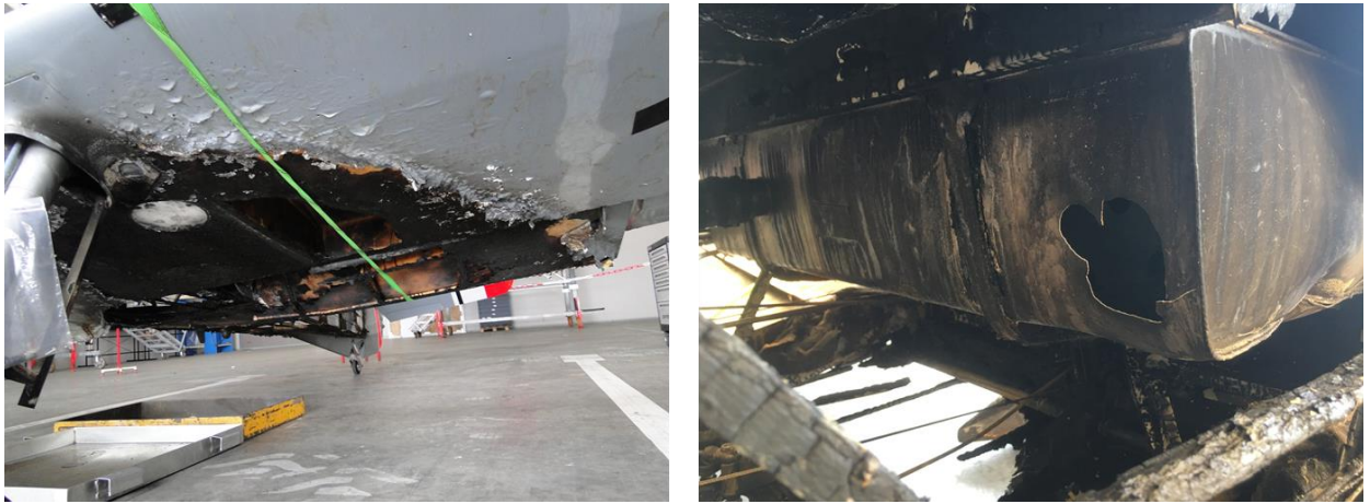
Figure 6 : intrados de l'aile gauche et réservoir arrière
