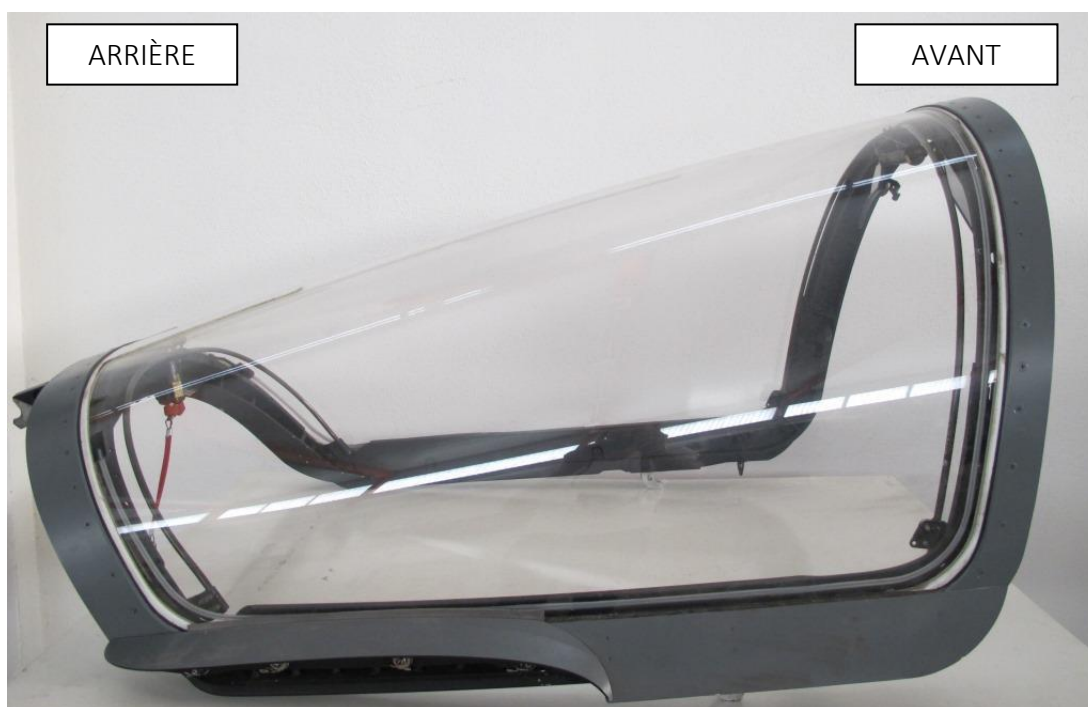
Figure 3 : verrière arrière après l'incident
