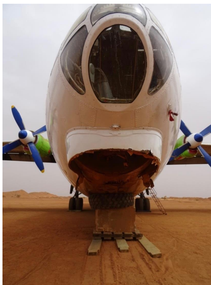
Figure 5 : état de la partie avant de l'appareil (capotage du radôme)
