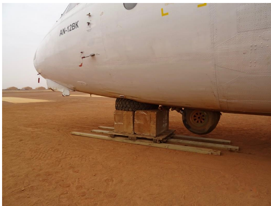
Figure 4 : train d'atterrissage avant replié en partie dans son logement de train (photo prise sur la zone de stockage de l'avion)
