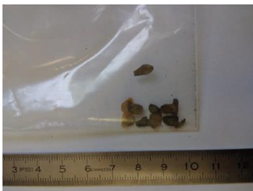
Figure 17 : corps étrangers retrouvés dans le circuit anémométrique le 3 août 2017
