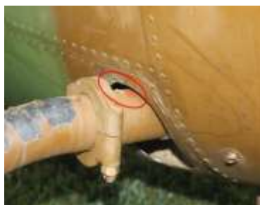
Figure 11 : détail du support de patin arrière gauche
