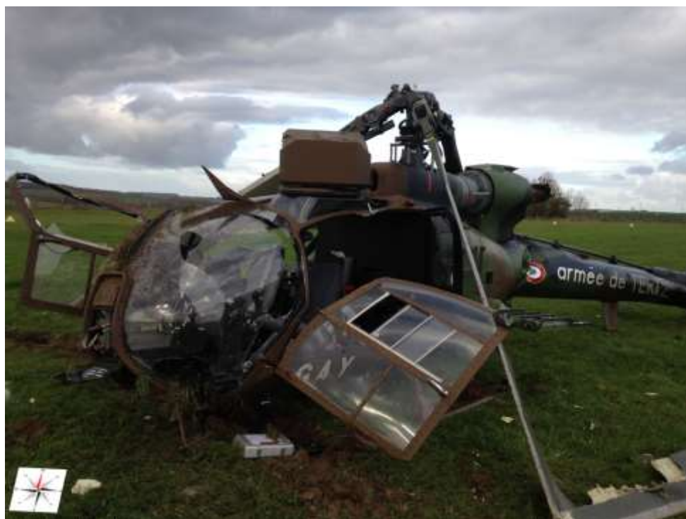
Figure 7 : vue générale des dommages à la cellule
