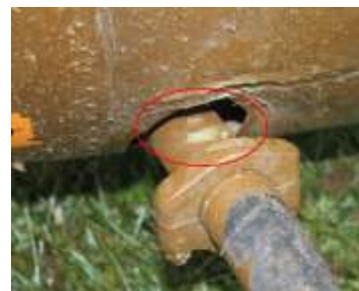
Figure 12 : détail du support de patin arrière droit
