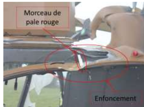
Figure 16 : vue du montant gauche de l'habitacle
