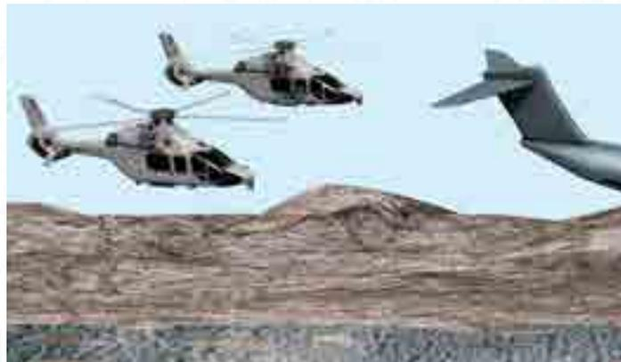
Hélicoptère polyvalent de 6 tonnes possédant une architecture modulaire permettant une grande évolutivité du système. Une base commune aux trois armées et des kits optionnels lui permettront de réaliser des missions très variées.
