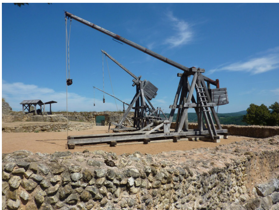
Trébuchet. Arme à contrepoids servie par une douzaine d'hommes. Poids des projectiles : 150 à 300 kg. Portée pratique : plus de 200 m., 300 dans quelques cas. Ce modèle est visible au musée de la guerre au Moyen Age de Castelnaud-la-Chapelle (24).
