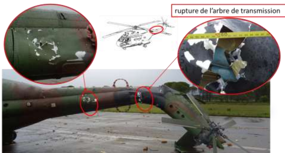
Figure 4 : pliure de la poutre de queue
