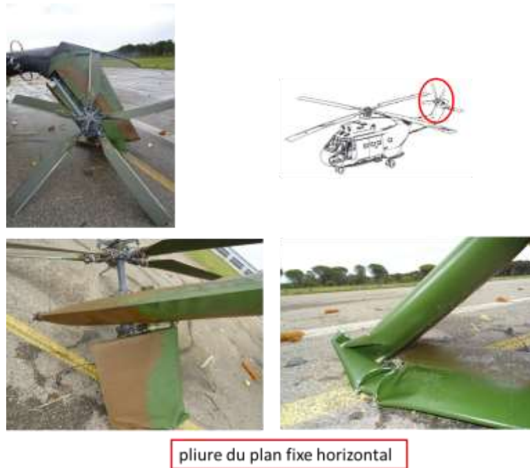
Figure 5 : dégâts du rotor anti-couple et du plan fixe horizontal
