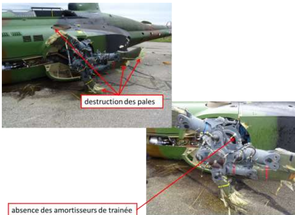
Figure 6 : endommagements du MRP et des pales
