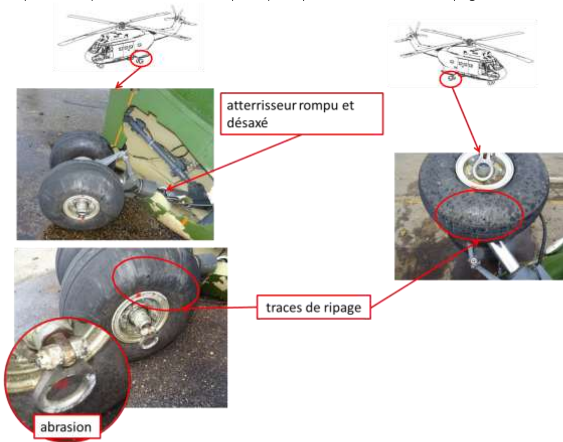
Figure 7 : dégâts des atterrisseurs principaux
