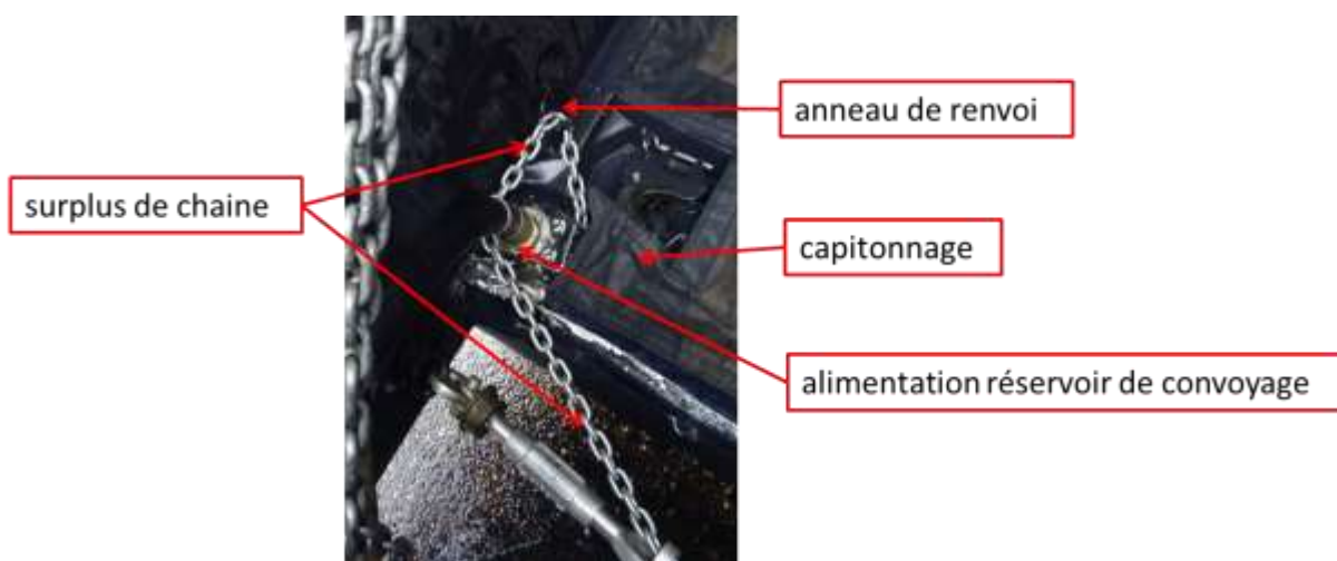
Figure 11 : disposition du surplus de chaîne de saisine
