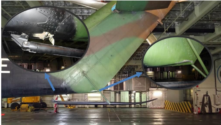
Poutre de queue et béquille
