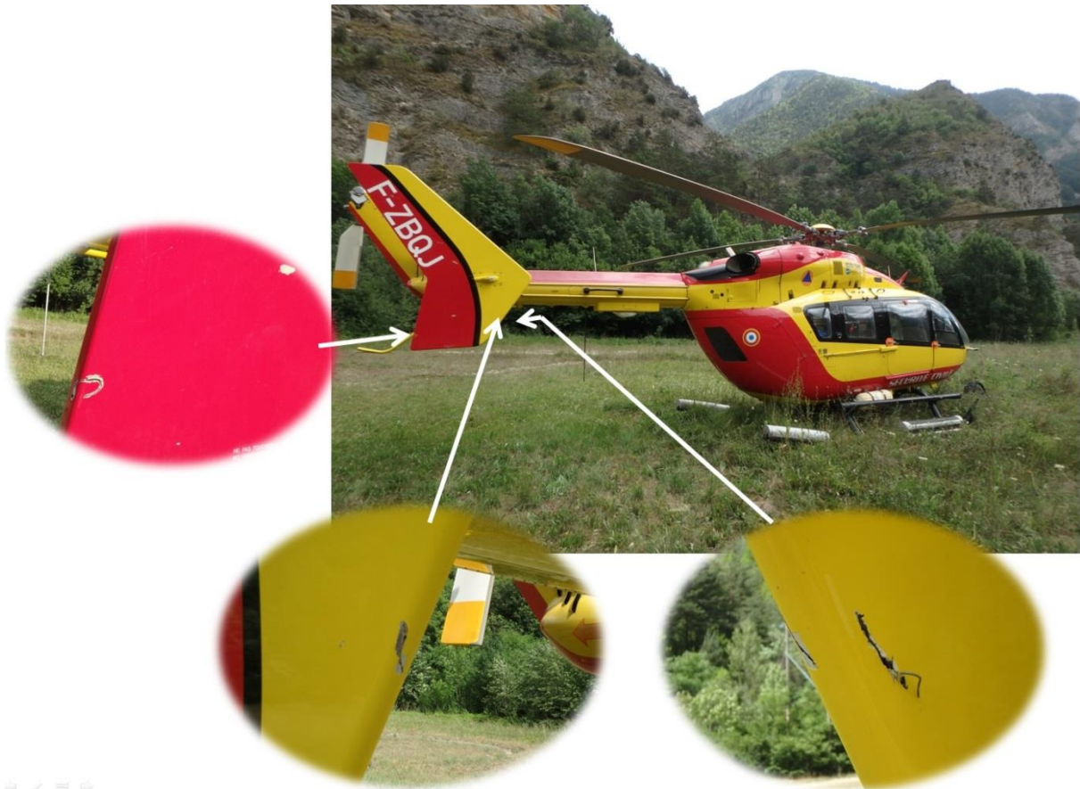
Figure 5 : dommages sur la partie droite de la cellule
