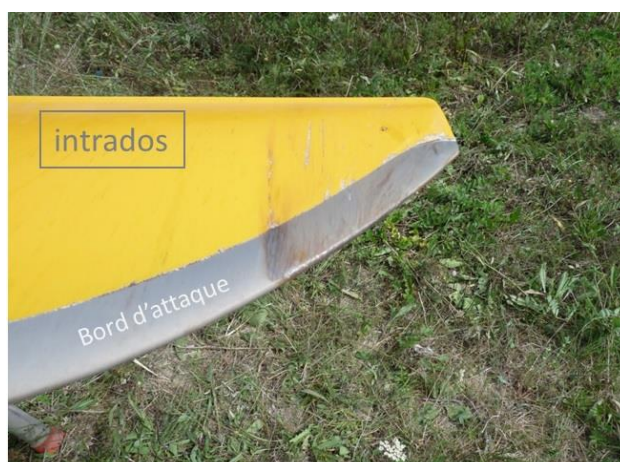
Figure 9 : trace de frottement en bout de la pale 3963
