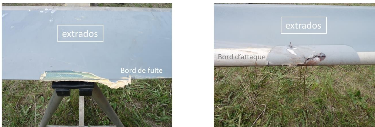
Figure 7 : traces de frottement à 2,33 m de son extrémité et impact sur la pale 3948
