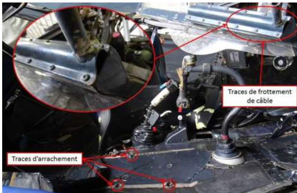
Figure 11 : vue des traces d'arrachement du siège pilote et des traces de frottement sur la sonde
