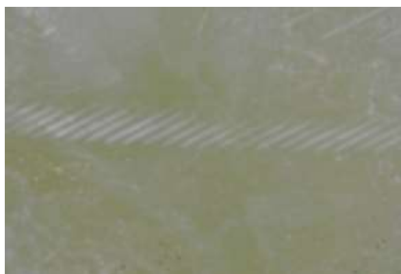
Figure 12 : Vue des traces de frottement sur le plexiglas
