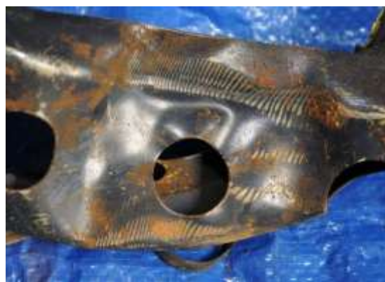
Figure 13 : vue des traces de frottement sur le carénage
