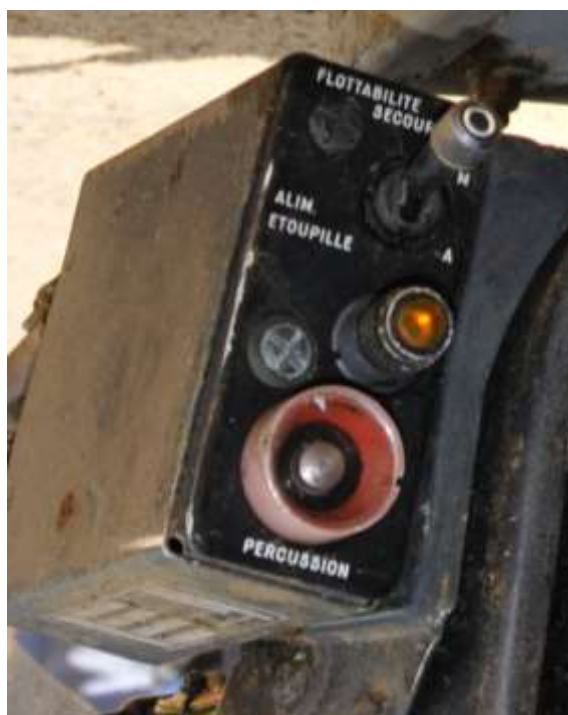
Figure 15 : vue du poste de commande de la flottabilité
