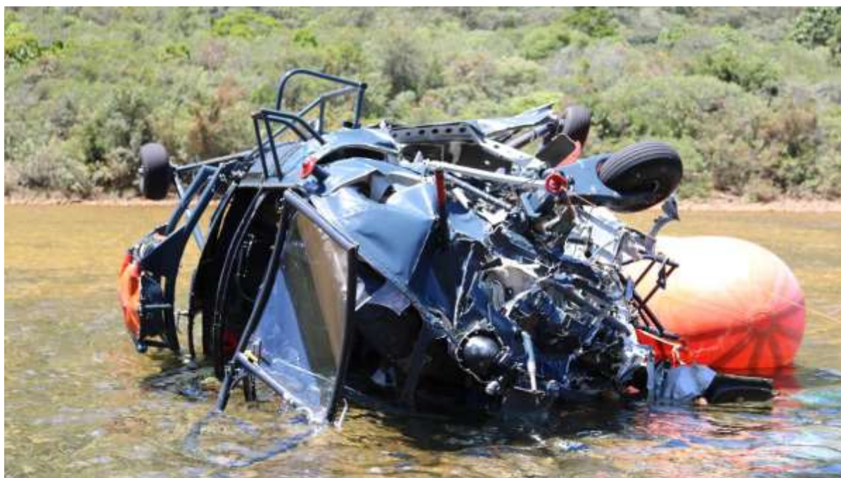
Figure 7 : vue de la cellule
