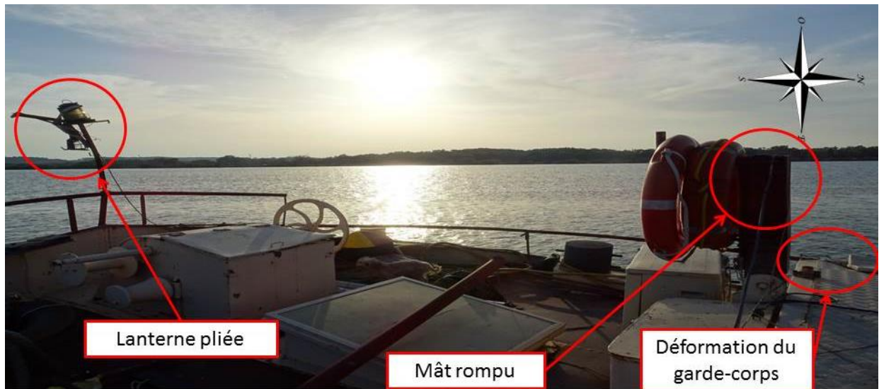
Figure 9 : vue des dommages sur la péniche
