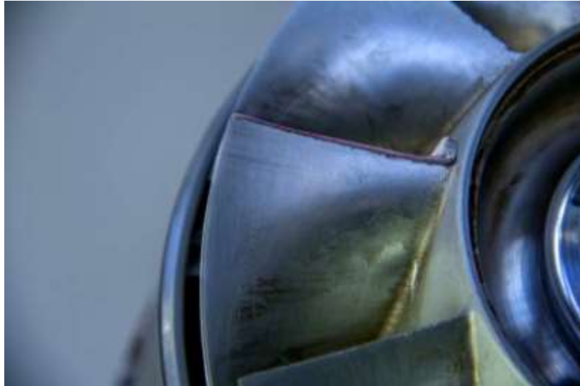
Contrôle érosion RM1 avec le gabarit prévu au manuel de réparation
