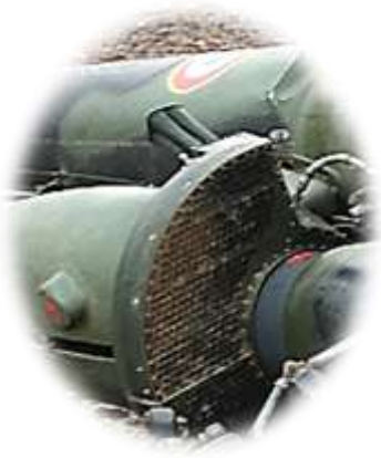
Entrée d'air du FAS
