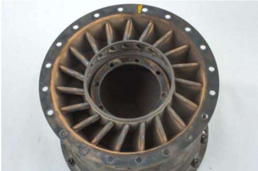
Vue générale du distributeur turbine 1 er étage
