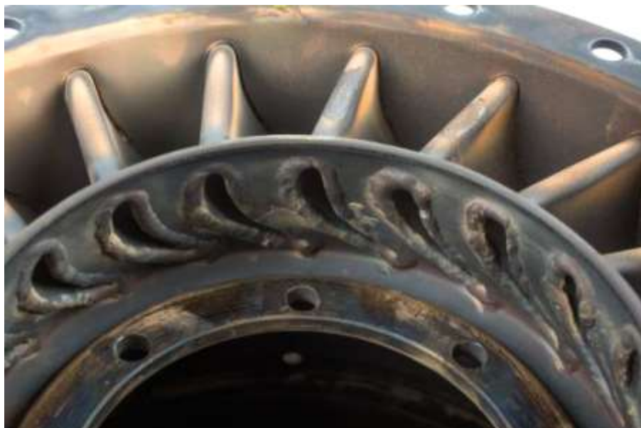
Dépôts de sable sur le bord d'attaque du distributeur turbine 1 er étage
