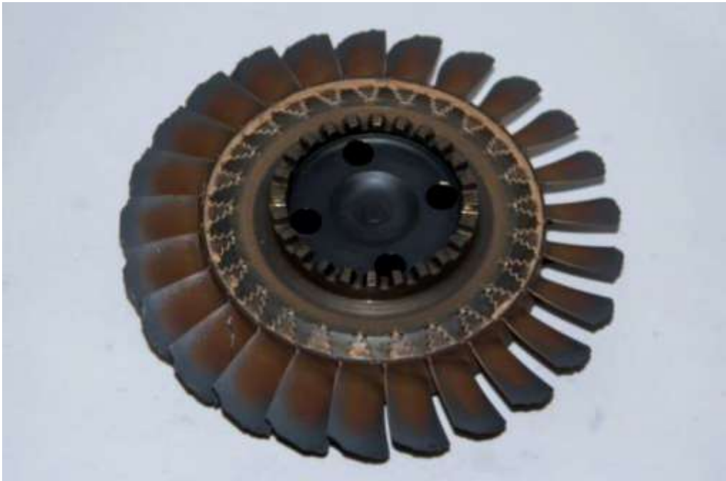
Roue turbine 2 ème étage
