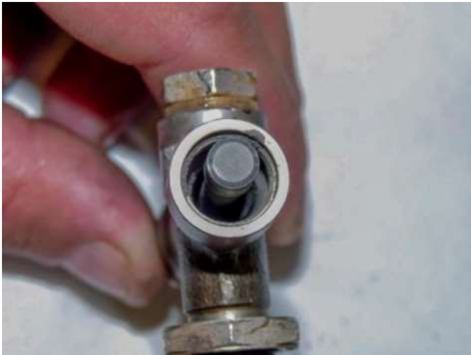
Présence de sable dans le logement du filtre
