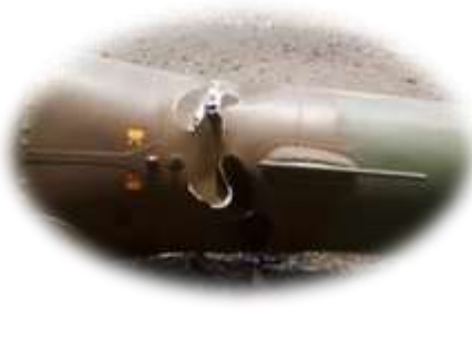
Pliure jonction poutre de queue - cellule
