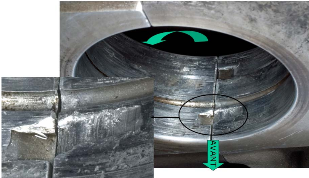
Traces de rotation des coussinets dans le carter
