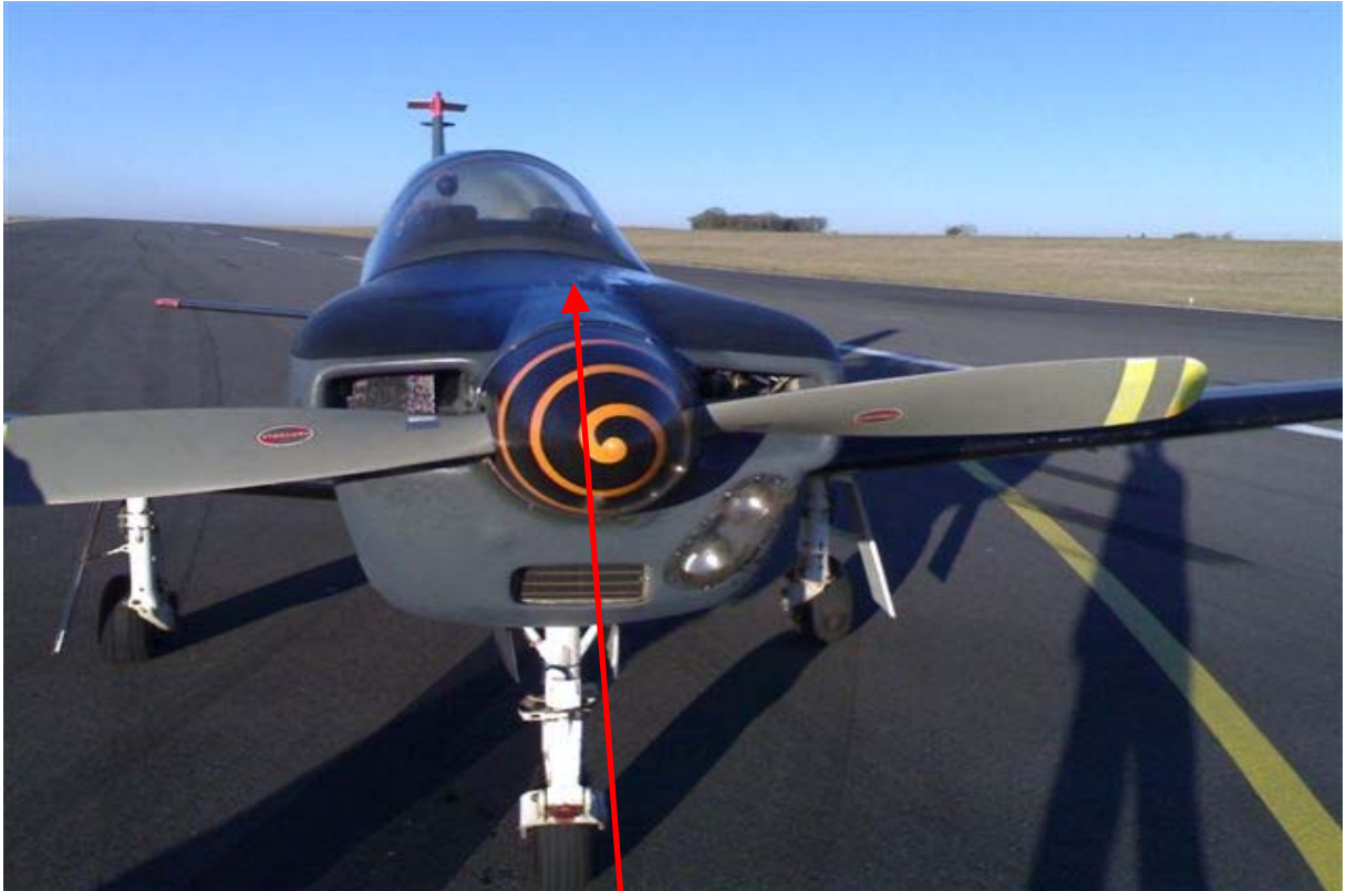
Traces d'huile sur les capots moteur
