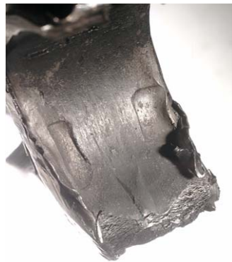
Marquage intérieur du pied de la bielle n° 5
