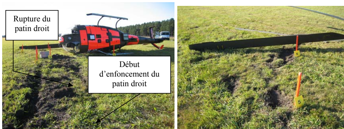
Photos 3 : saignées couteau coup câble et patin droit ; impacts rotor
