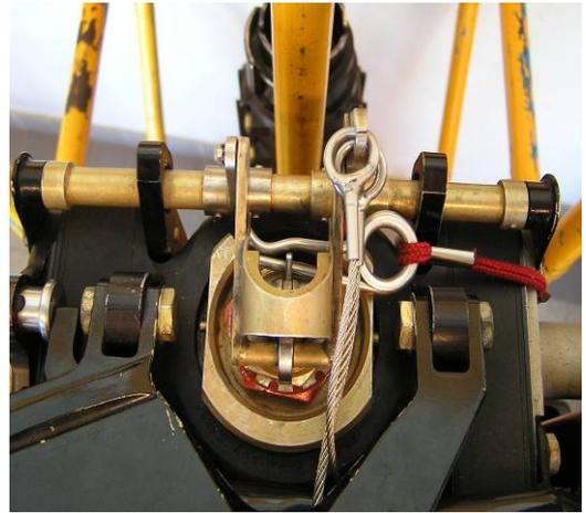
*Photo 5 : Positionnement correct de l'épingle du percuteur principal*
