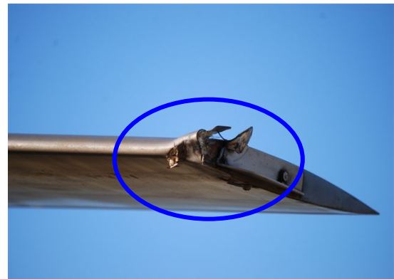
Photo 10 et 11: impact sur la pale principale rouge
