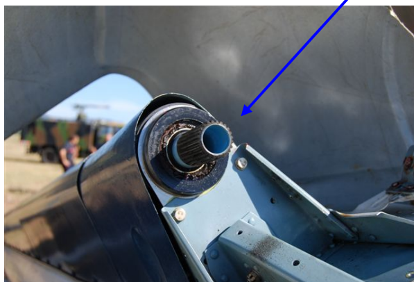
Photo 4 : embout cannelé de l'arbre arrière de transmission
