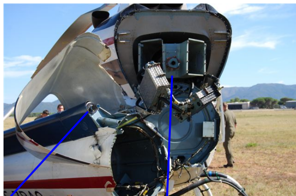
Photo 3 : rupture de la poutre de queue
