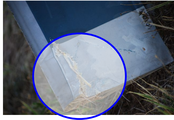
Photo 9 : impact sur la pale de rotor anti-couple
