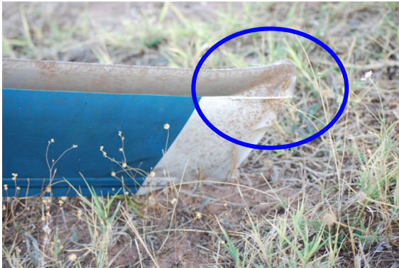
Photo 8 : impact sur la pale de rotor anti-couple
