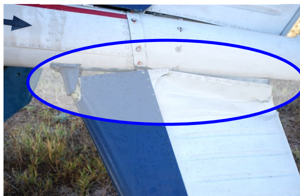
Photo 7 : déformation de la dérive inférieure
