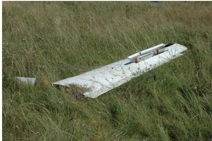
Photo 6 : morceau de l'aile droite
