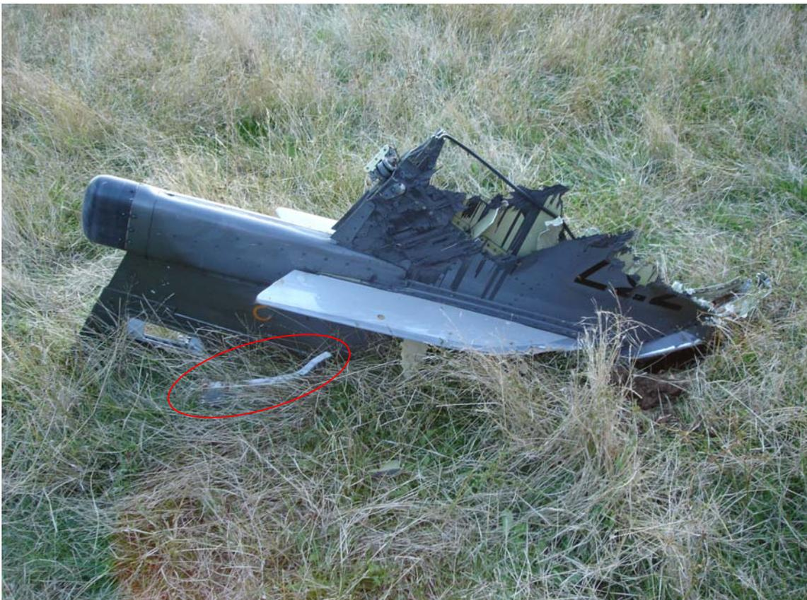
*Photo 5 : Partie supérieure de la dérive du Mirage 2000 N sectionnée et morceau de la lame du train principal droit de l'ULM (cercle), telles que retrouvées au sol*
