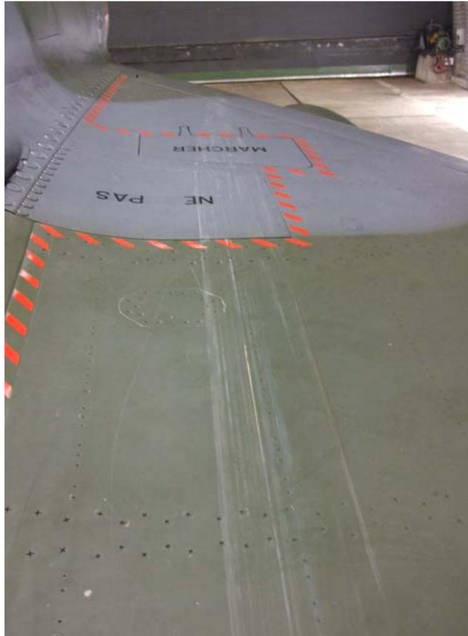
*Photo 6 : Traces de frottement sur l'extrados de la voilure droite du Mirage 2000 N*
