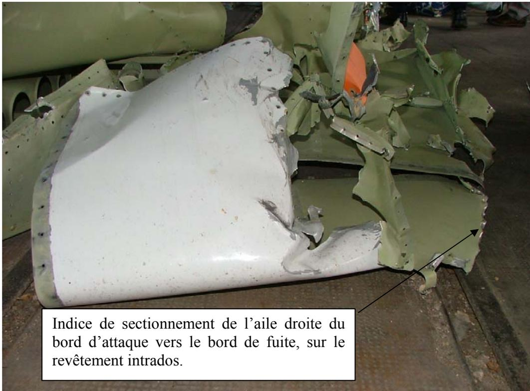
*Photo 2 : Sectionnement du carénage du bord d'attaque de l'aile droite de l'ULM*
