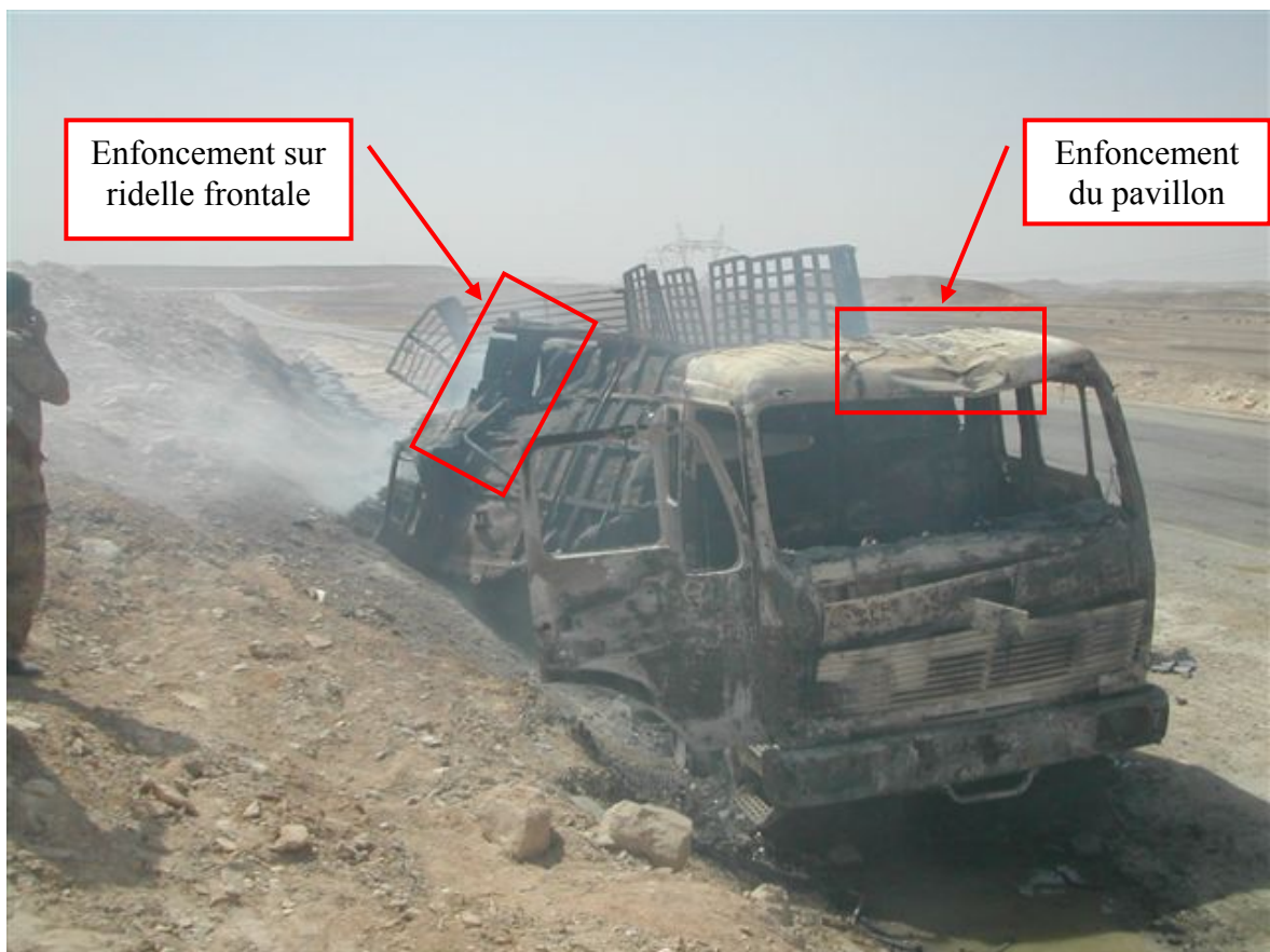
Traces de la collision sur l'épave du camion heurté par l'aile gauche de l'avion
