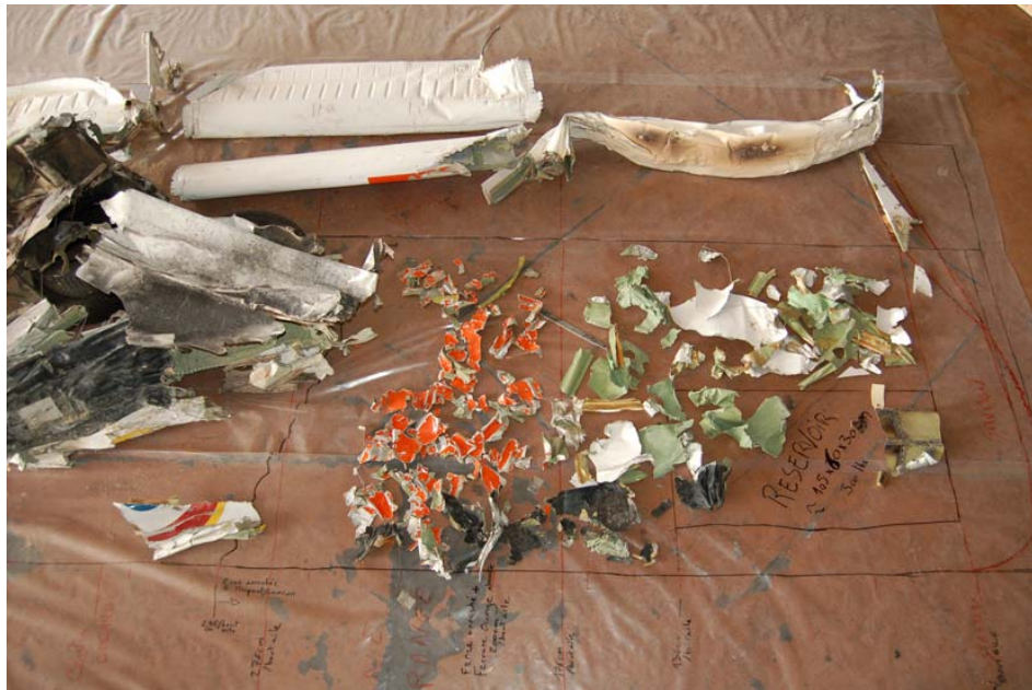
Aspect des débris de l'aile retrouvés près du camion et positionnés sur canevas
