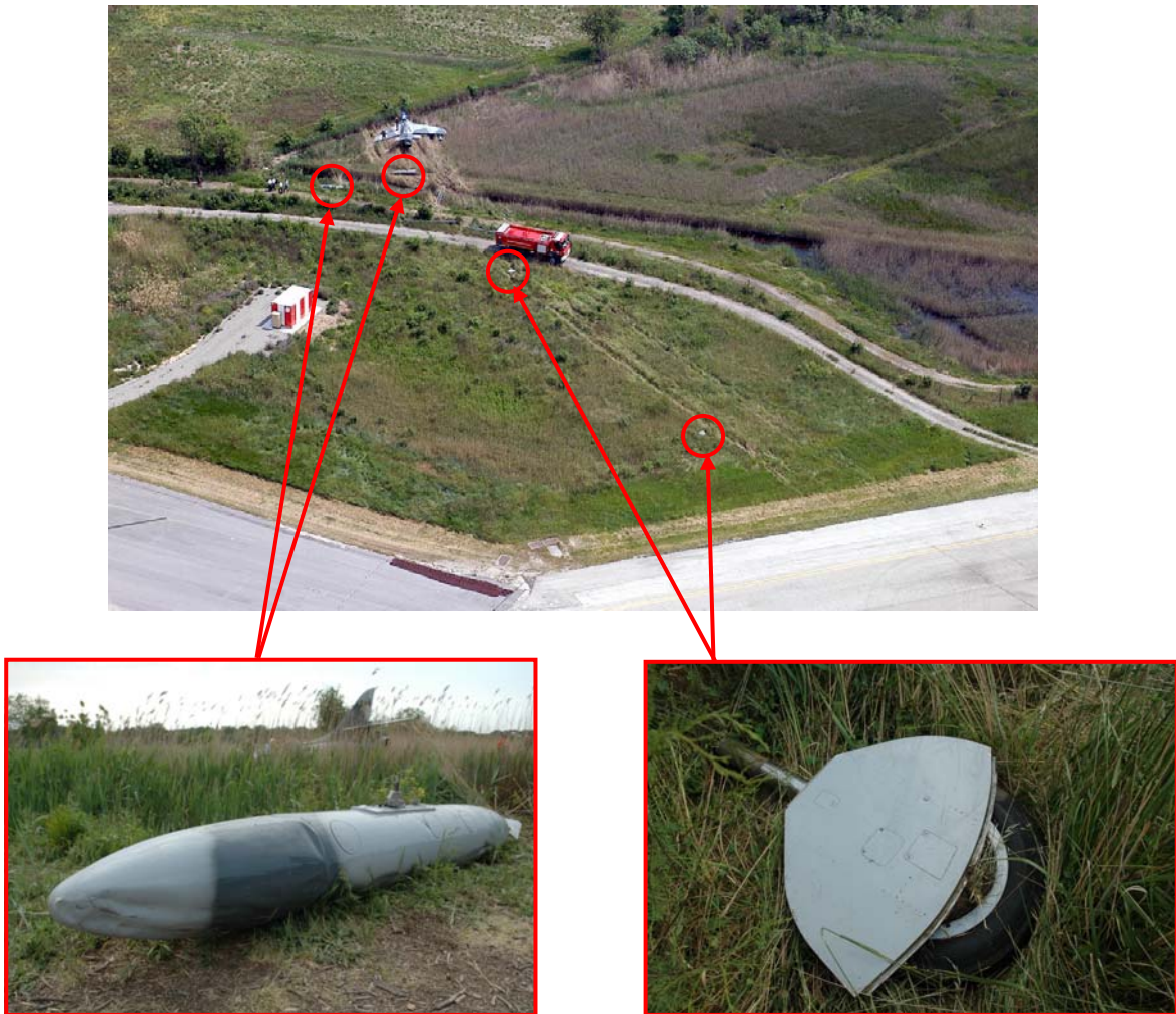
Photo 5 : Localisation des trains principaux et des deux réservoirs pendulaires gauches
