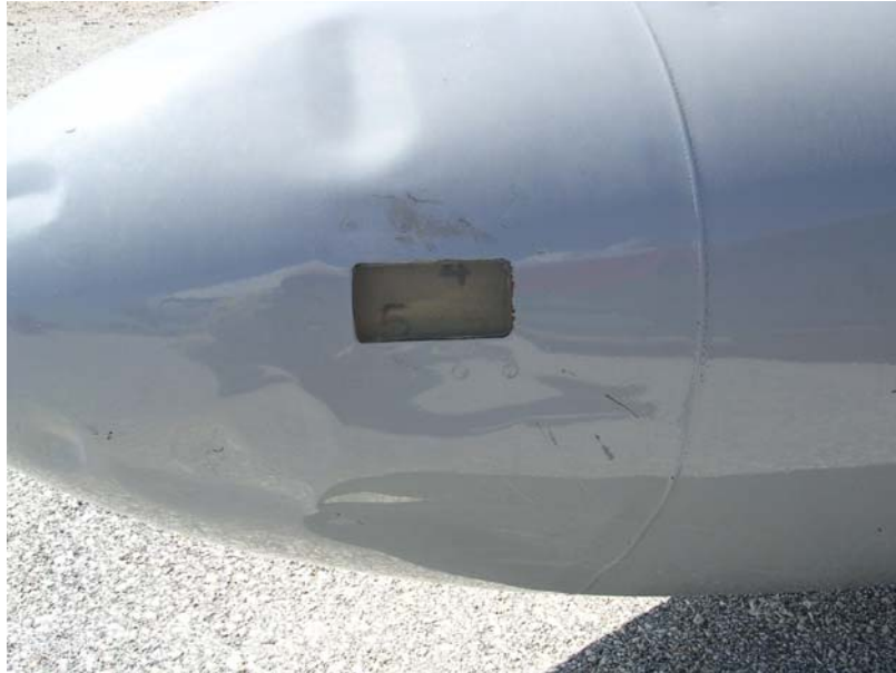
Photo 1 : Jauge mécanique interne du réservoir pendulaire 230UKG droit
