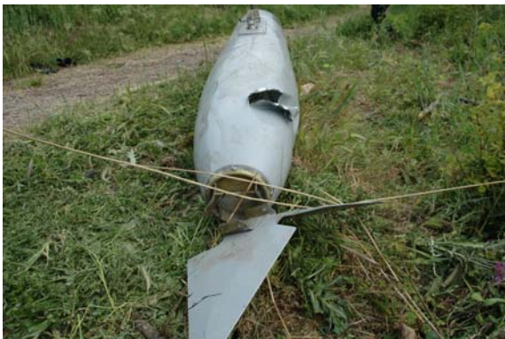
Réservoir pendulaire gauche extérieur
