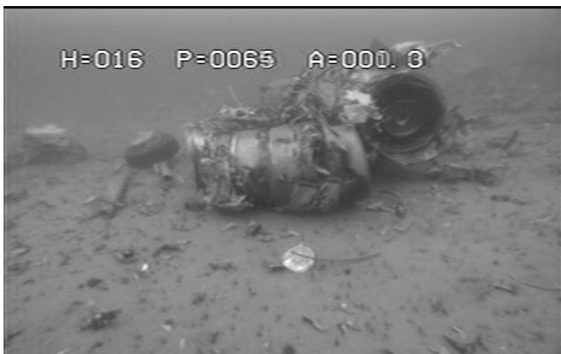
Photo 3 : Vue du moteur cassé en deux parties
