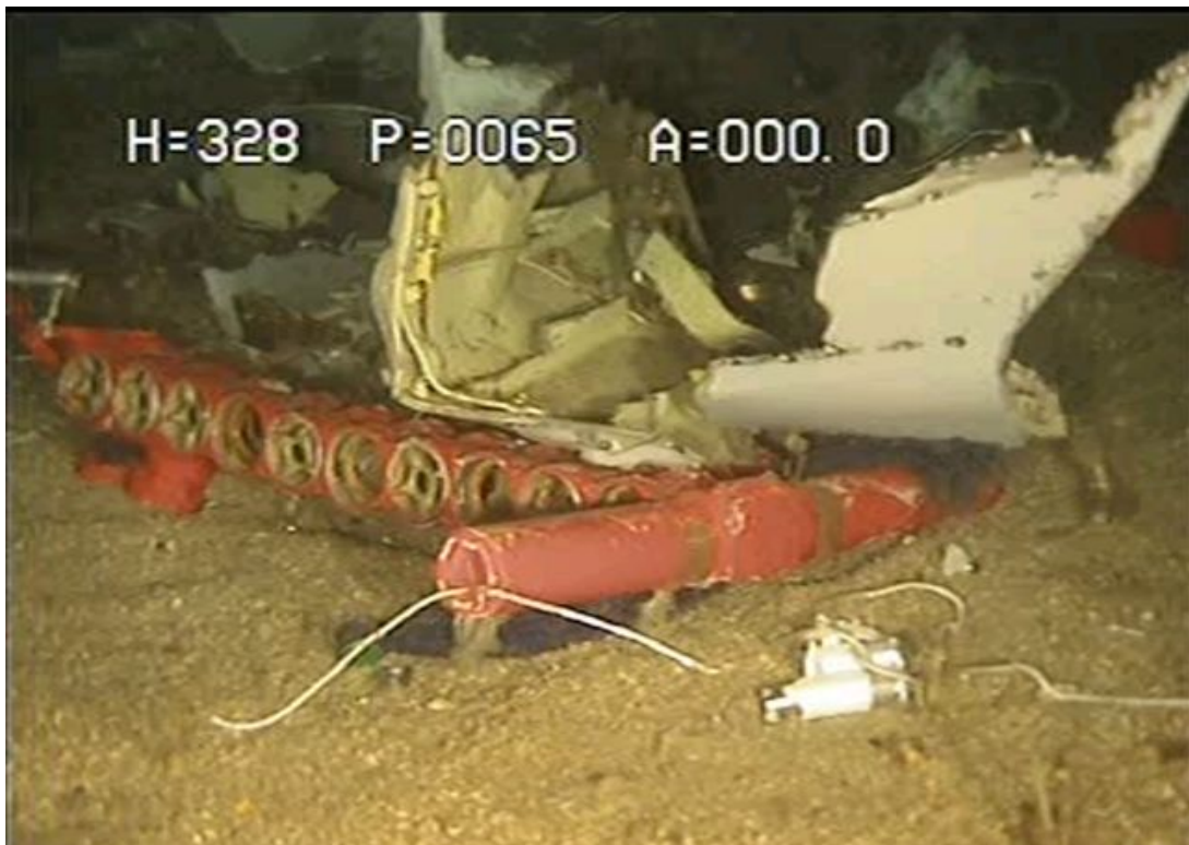
Photo 5 : Vue d'une partie des fusées du siège éjectable non consommées
