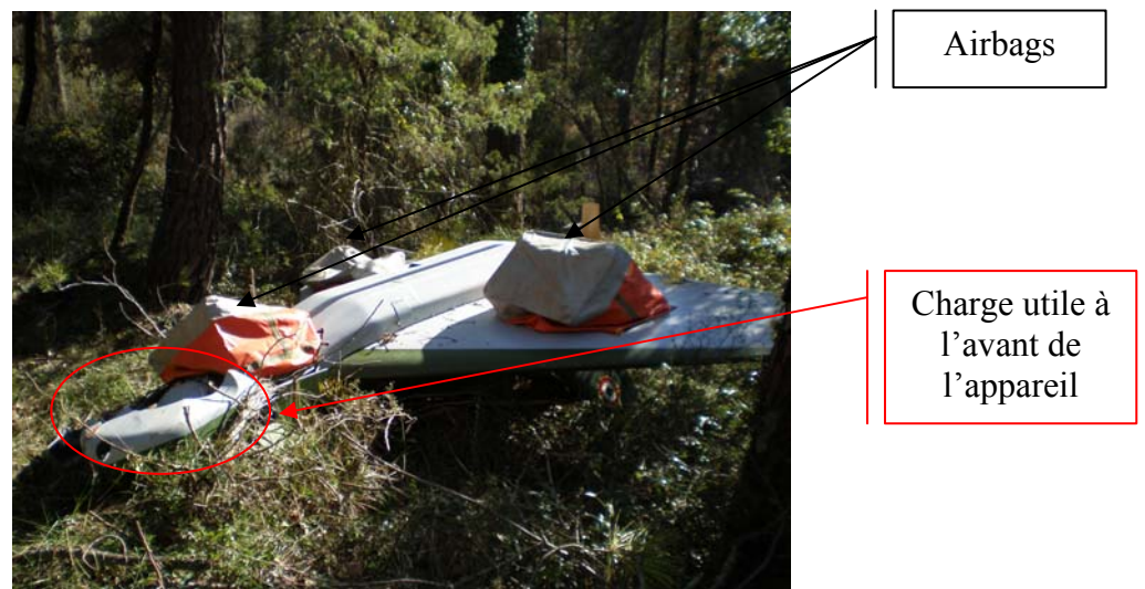
Photo 2 : vue détaillée du drone retourné sur le sol
