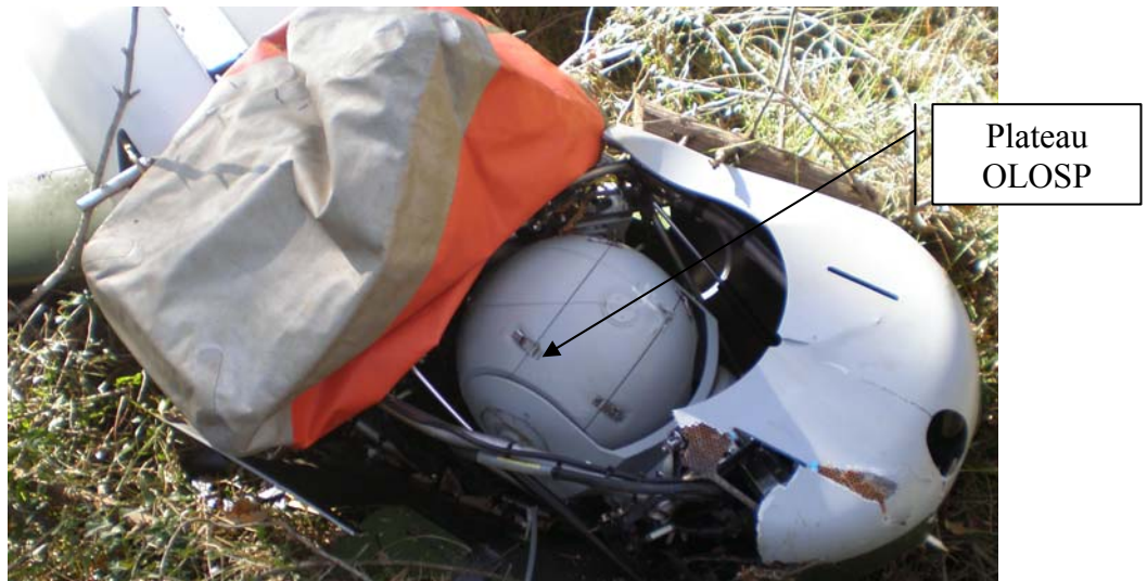
Photo 3 : vue générale de la charge utile endommagée
