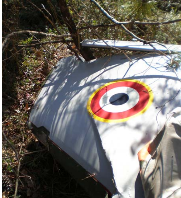
Photo 4 : partie intrados de l'aile gauche déchirée
