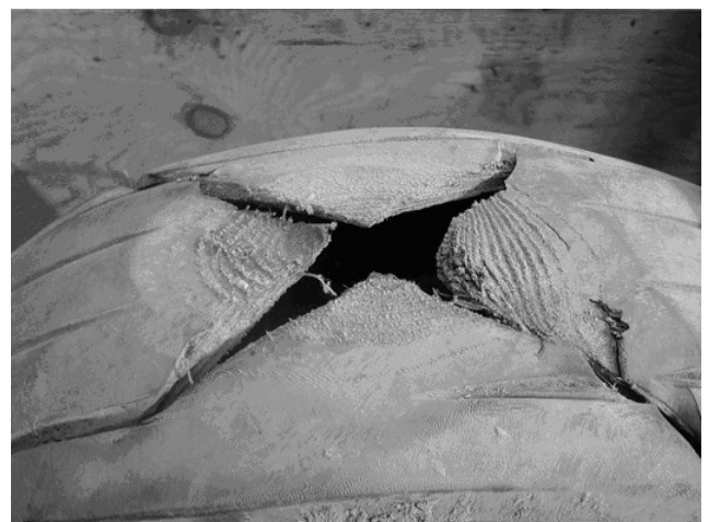
Détérioration du pneu de la roue intérieure de l'atterrisseur principal gauche
