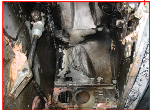
Photo 6 : habillage du logement du train auxiliaire
