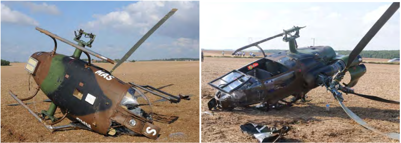
Vues de la structure centrale endommagée
