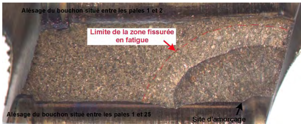
Vue du faciès de rupture du disque
