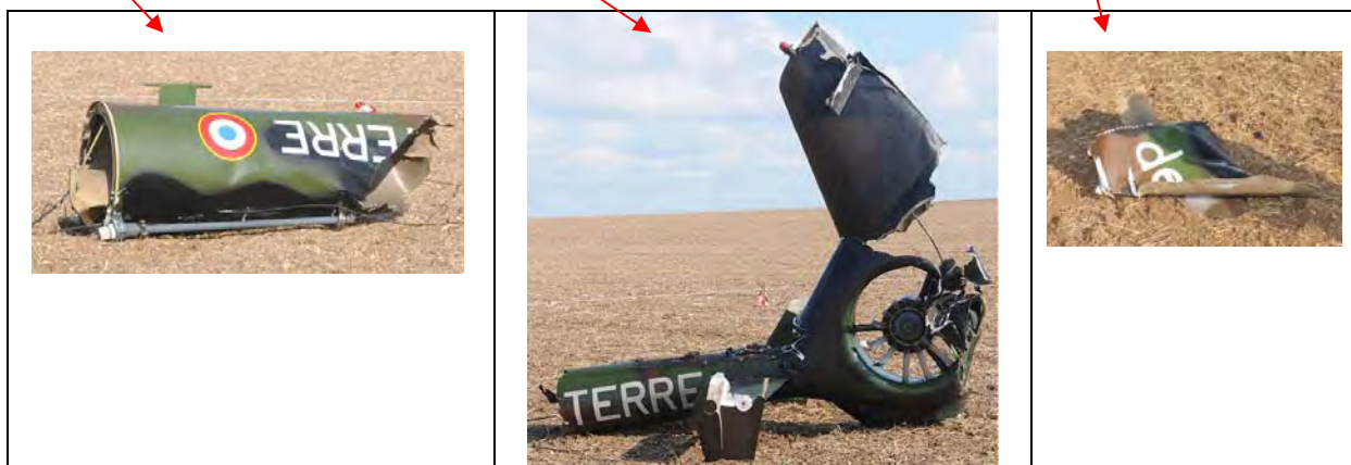
Éléments endommagés de la poutre de queue
