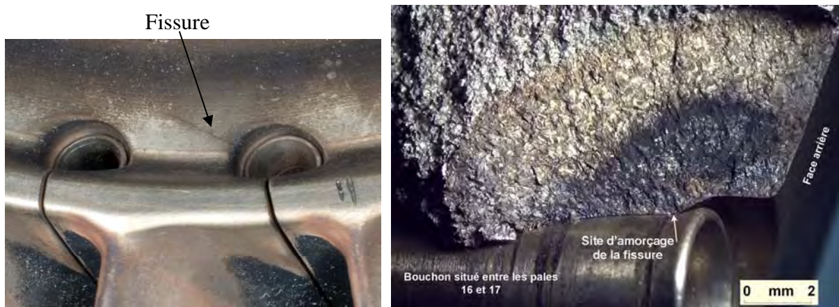
Vue de la seconde fissure trouvée sur le disque face arrière et du faciès de rupture associé
