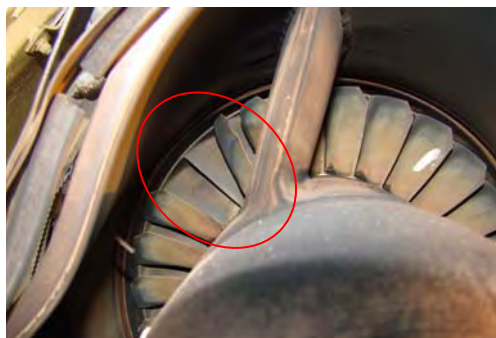
Absence d'une pale du disque du troisième étage de turbine
