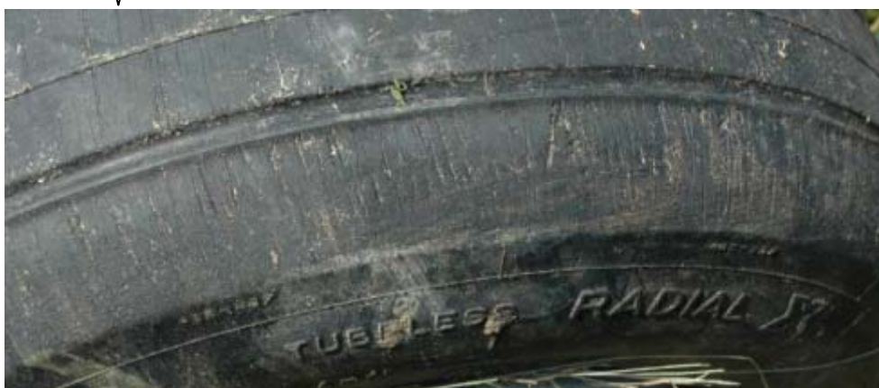
Détail des traces de ripage sur le flanc gauche de la roue gauche du train auxiliaire
