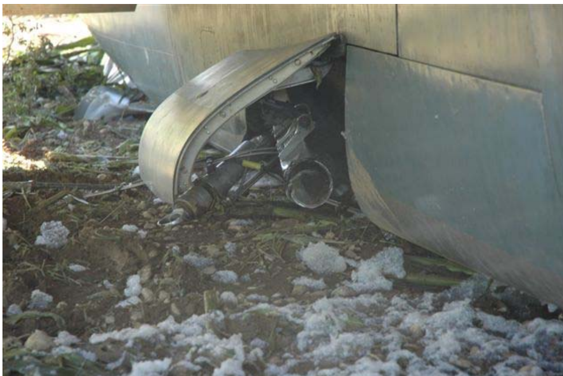
Vue du train principal droit rompu
