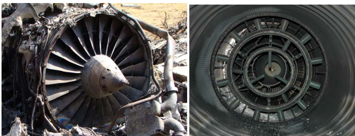
Entrée du compresseur, sortie de turbine et canal PC
