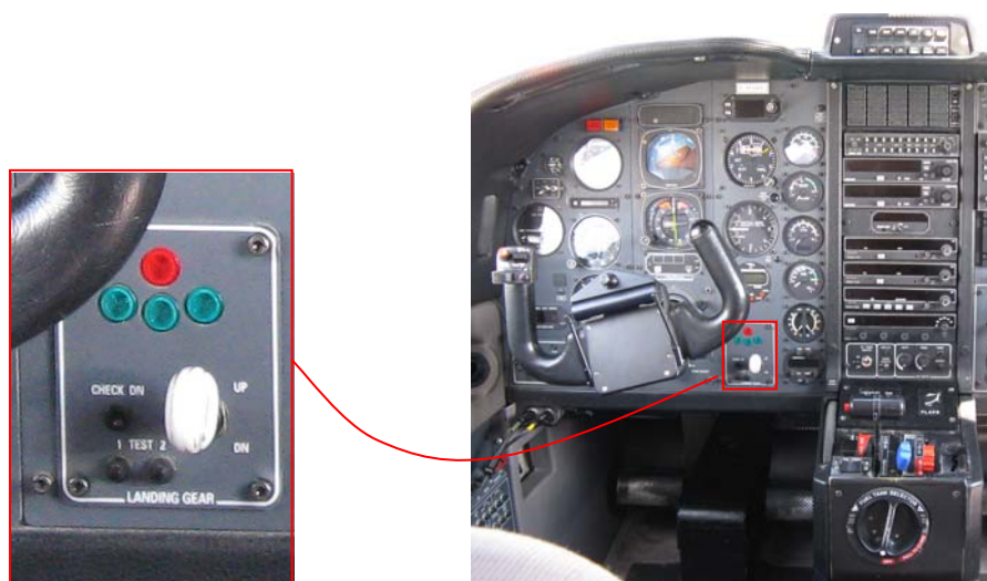
Emplacements de la commande de train
