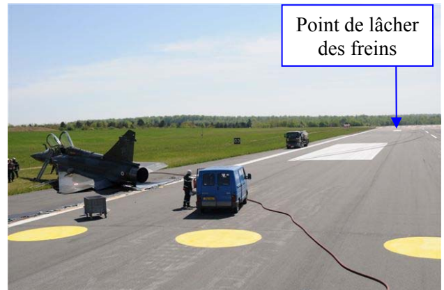
Positionnement de l'appareil immobilisé sur le bord droit de la piste 02 et traces de pneumatiques
