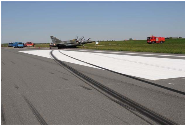
Positionnement de l'appareil immobilisé sur le bord droit de la piste 02 et traces de pneumatiques
