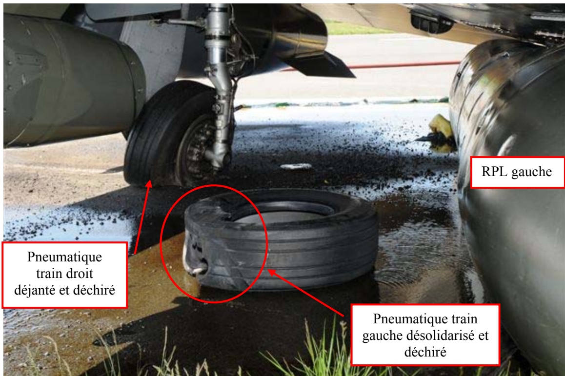
Etat des pneumatiques des trains principaux
